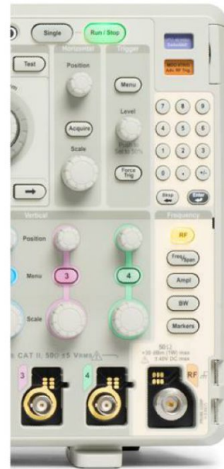
Основные параметры спектра могут быть быстро настроены с помощью специализированных органов управления на передней панели.
